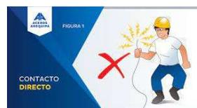
Es el contacto físico de personas con partes activas de instalaciones y equipos. Se consideran partes activas; los conductores y piezas conductoras bajo tensión en servicio normal.
