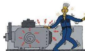
Ocurre cuando las personas entran en contacto con masas puestas accidentalmente bajo tensión. Por ejemplo, estructuras metálicas que en funcionamiento normal no tienen tensión, pero que pueden adquirirla por un defecto interno de instalación.
